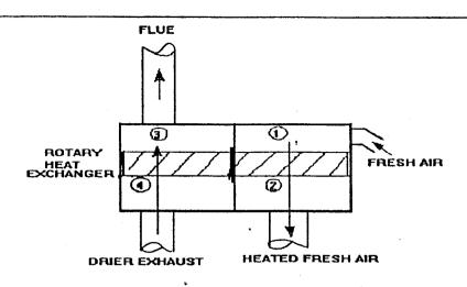
FIG 1. WASTE HEAT RECOVERY SYSTEM
